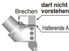
Durch zusätzliche Bearbeitung des Schafts des Werkzeughalters, wie in der Abb. gezeigt, wird ein sicheres Einspannen erreicht.
