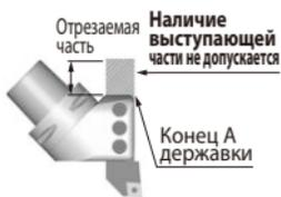
Дополнительная обработка державки квадратного сечения так показанным на рисунке способом может обеспечить более безопасное крепление.
