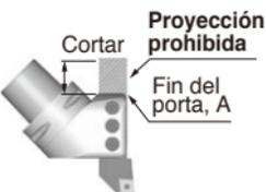
Mecanizados adicionales en el mango del porta de cuadradillo como el de la imagen, pueden asegurar la sujeción.
