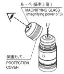
小径工具の刃先位置測定時には、保護 カバ・に装着しているル・ペ(倍率5 倍)ご使用ください。
